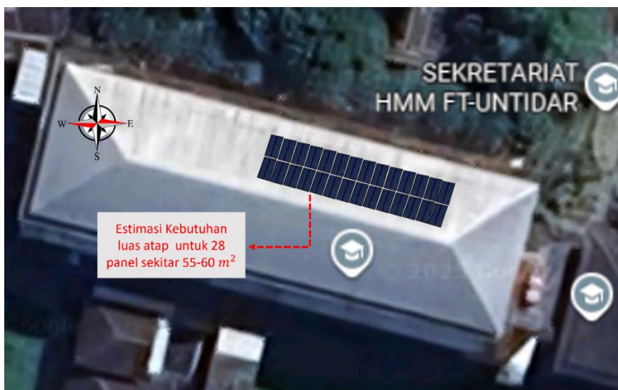
Gambar 5 Visualisasi Pemasangan 28 Modul Panel Surya Berkapasitas 9 kWp pada Gedung Fakultas Teknik 2 Universitas Tidar
