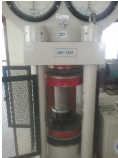
Gambar 3. Pengujian Kuat Tekan Benda Uji
