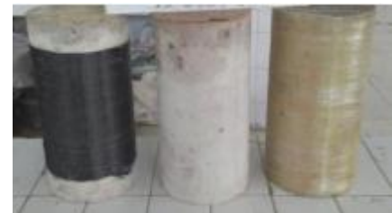
Gambar 8. Silinder Beton Tanpa diperkuat dan yang diperkuat CFRP, GFRP (Tarigan et al., 2018)
