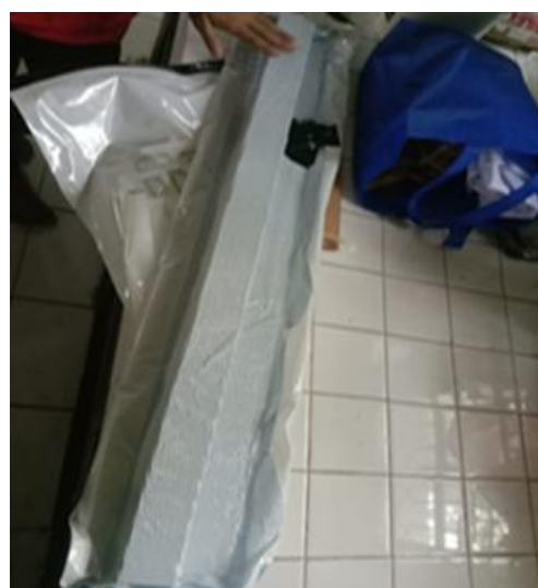
Gambar 2. Pemvakuman balok glulam dalam tas vakum ( vacuum bagging )
