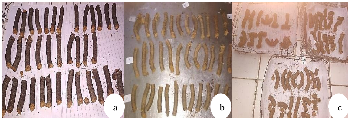
Gambar 1. Pelet kayu dari limbah gergajian: (a) kayu benuas (b) kayu melur (c) kayu jelutung rawa
