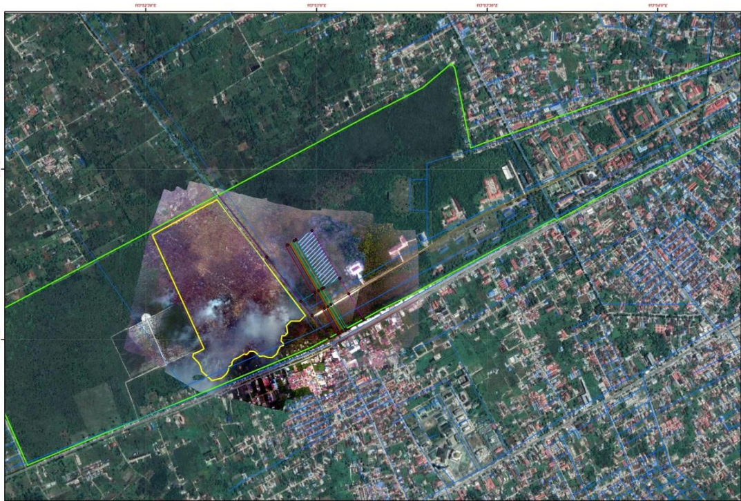
Gambar 7. Penggunaan citra Landsat untuk peta dasar yang dioverlaykan dengan peta Orthophoto penerbangan di lokasi penelitian
