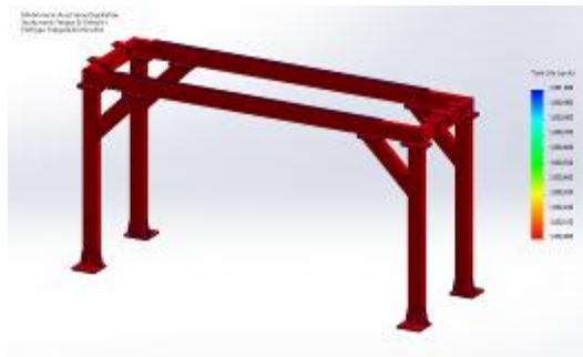
Gambar 7. Hasil Analisis Fatigue ( Total Life ) di Posisi B
