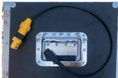
Gambar 7. Kabel penghubung antara katoda dan kabel geolistrik
