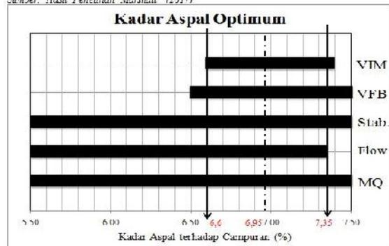
Setelah didapat hasil Kadar Aspal Optimum (KAO) seperti pada Tabel dan Gambar diatas kemudian plotkan hasilnya ke dalam Grafik Stabilitas, Marshall Quotient, *flow*, VIM dan VFB masing – masing Komposisi campuran untuk mendapatkan Nilai Parameter Marshall berdasarkan Kadar Aspal Optimum (KAO). Hasil plotting Nilai Parameter Marshall berdasarkan Kadar Aspal Optimum (KAO) dapat dilihat pada Tabel berikut:
