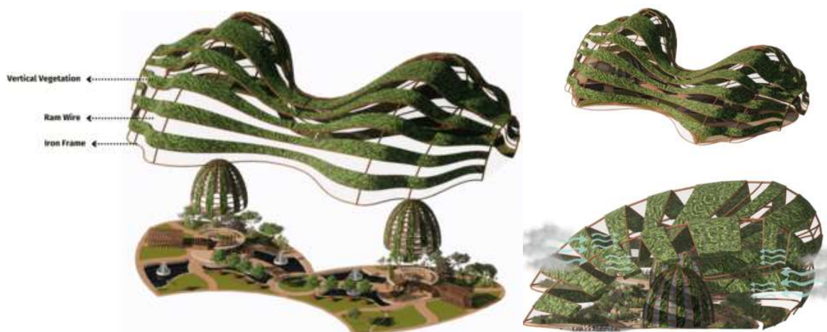
Gambar 7. Skematik Bangunan Butterfly Conservatory Sumber : Penulis (2025)
