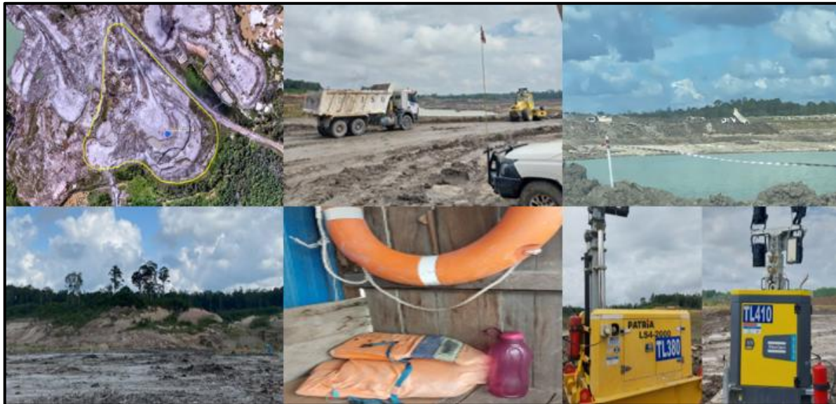
Gambar 13. Kondisi Disposal Meranti: (a) Area Disposal , (b) Tanggul, (c) Dumping di Tepi Air/Ketinggian, (d) Kondisi Lereng, (e) Perlengkapan Keselamatan, dan (f) Penerangan/ Tower Lamp
