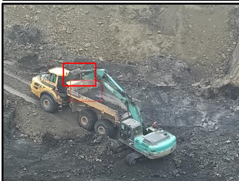
Gambar 6. Adanya Material Pengotor Yang Menempel Pada Alat Gali, Muat dan Angkut Pada Saat Kegiatan Coal Getting
