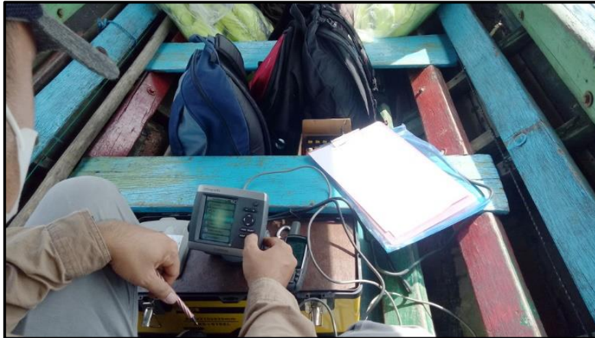
Gambar 2. Pengukuran Batimetri Menggunakan GPS Garmin 420 (Sonder Single Beam)
