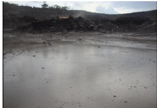
Gambar 2. Kondisi loading point berlumpur
