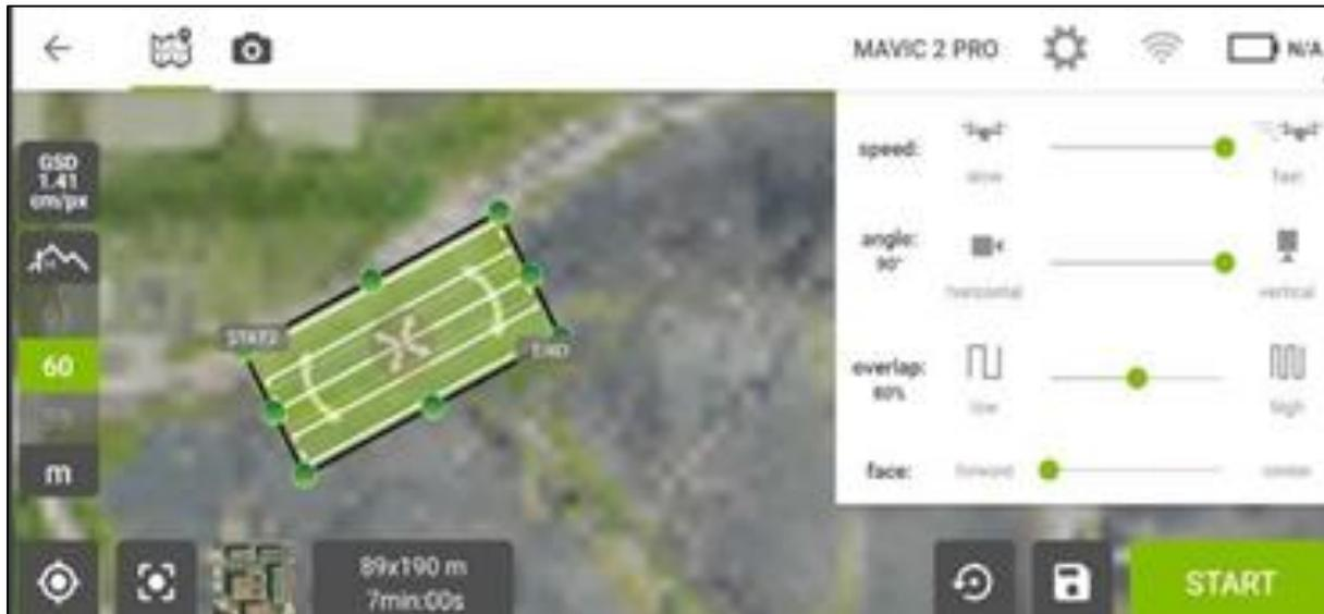
Gambar 3 Pembuatan Jalur Terbang Drone
