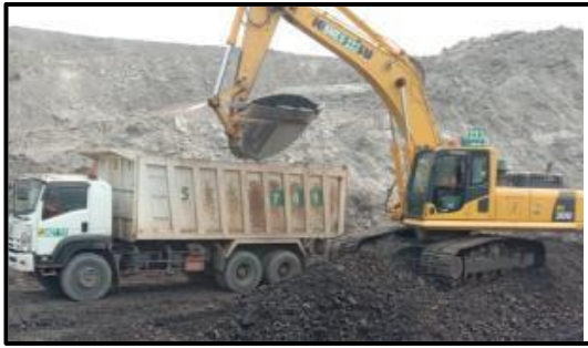
Gambar 5. Roda Alat Berat untuk Coal Getting Masih Membawa Material Pengotor.
