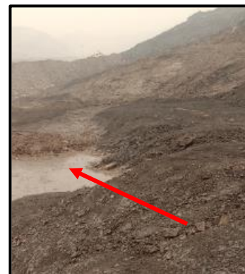
Gambar 4. Genangan Air di Atas Permukaan Batubara Yang Akan di Coal Getting
