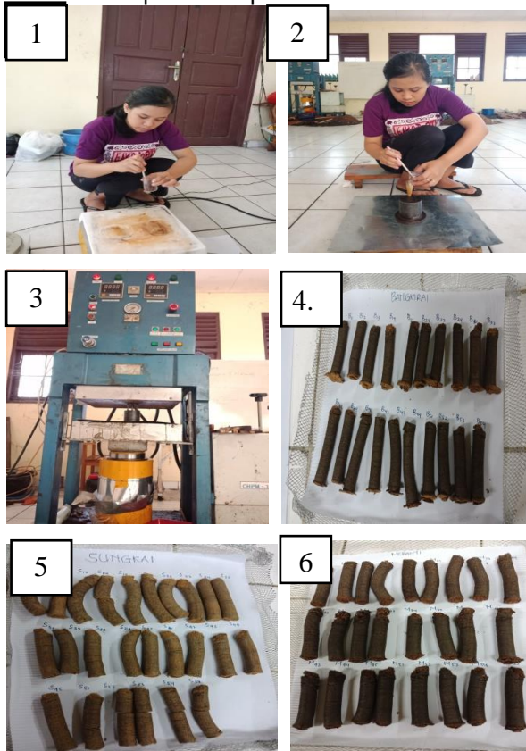
Keterangan : 1. Pencampuran serbuk kayu dengan adonan perekat; 2. Hasil campuran dimasukkan ke dalam alat pencetak pelet kayu; 3. Pengepresan pelet kayu dengan alat pengempa hidrolis; 4. Pelet kayu Bangkirai; 5. Pelet kayu Sungkai; 6. Pelet kayu Meranti Merah
