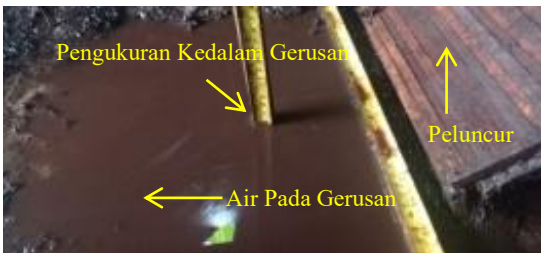
Gambar 15. Pengukuran Kedalaman Gerusan
