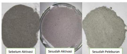
**Gambar 4.** Hasil abu layang setelah proses peleburan dengan NaOH
